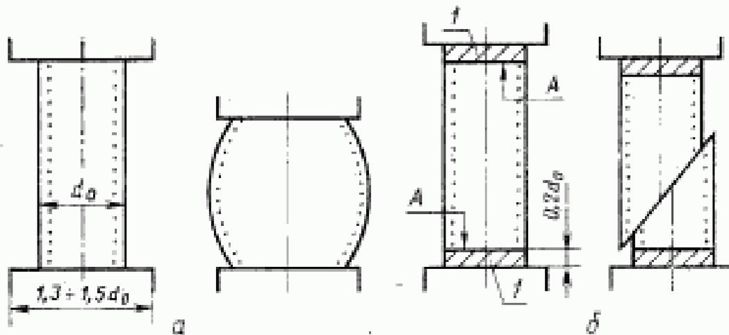
а—образцы с пластическим типом деформирования; б—образцы с хрупким типом деформирования; 1—стальные или латунные штампы
