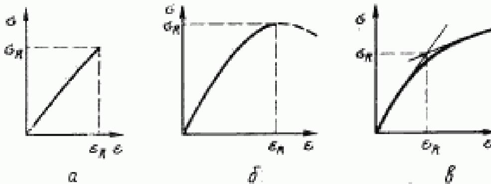
а—хрупкий тип деформирования; б—хрупко-эластический тип деформирования; в—пластический тип деформирования
