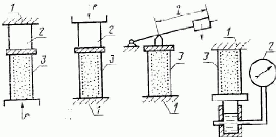
1—выпадающая опорная площадка; 2—силовометр (динамометр, тензодатчики и т. п.); 3—испытуемый образец
