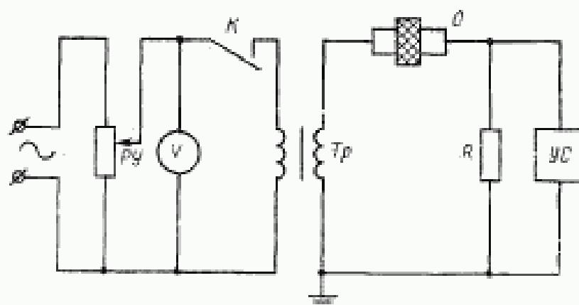
Тр—высоковольтный испытательный трансформатор;  $R$ —резистор;  $R_U$ —регулятор напряжения;  $O$ —образец с электродами;  $V$ —вольтметр для измерения напряжения пробоя;  $УС$ —устройство сигнализации о наступлении пробоя;  $K$ —контакт устройства сигнализации, отключающей первичную цепь трансформатора в момент пробоя образца
