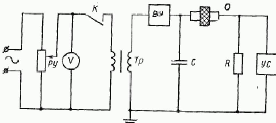
*T<sub>P</sub>*—высоковольтный испытательный трансформатор; *R*—резистор; *R<sub>U</sub>*—регулятор напряжения; *O*—образец с электродами; *V*—вольтметр для измерения напряжения пробоя; *BU*—выпрямительное устройство; *C*—конденсатор; *UC*—устройство сигнализации о наступлении пробоя; *K*—контакт устройства сигнализации, отключающий первичную цепь трансформатора в момент пробоя образца
