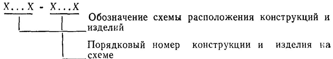
Обозначение схемы расположения конструкций и изделий состоит из одной или двух букв; при наличии нескольких схем однотипных конструкций буквенное обозначение дополняется порядковым номером.
