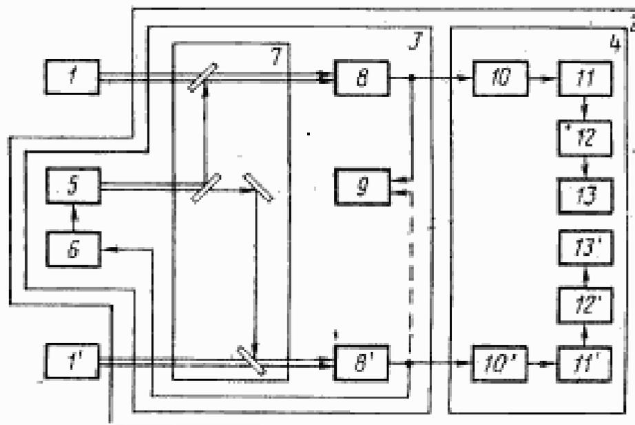
1—исследуемый стабилизированный лазер; 1'—опорный стабилизированный лазер; 2—СИ; 3—оптическая часть СИ; 4—измерительно-индикационная часть СИ; 5—опорный лазер-гетеродни; 6—устройство управления частотой; 7—оптическая система; 8, 8'—измерительные преобразователи; 9—устройство контроля; 10, 10'—усилители-ограничители; 11, 11'—частотные детекторы; 12, 12'—переключаемые аппроксимирующие фильтры; 13, 13'—измерители среднеквадратического значения напряжения
