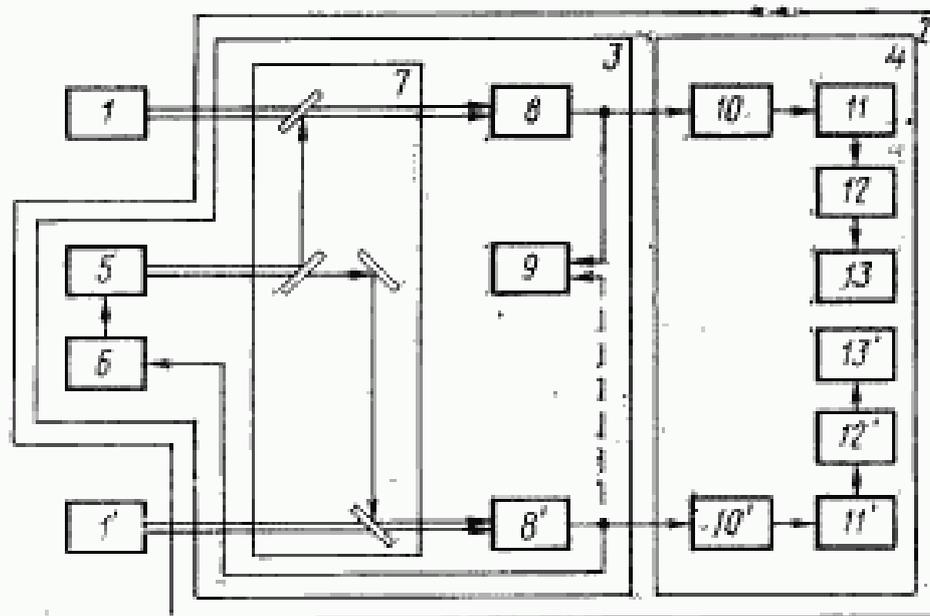
1—исследуемый стабилизированный лазер; 1'—опорный стабилизированный лазер; 2—СМ; 3—оптическая часть СМ; 4—измерительно-индикационная часть СМ; 5—опорный лазер-гетеродин; 6—устройство управления частотой; 7—оптическая система; 8, 8'—измерительные преобразователи; 9—устройство контроля; 10, 10'—усилители; 11, 11'—цифровые измерители; 12, 12'—устройство ввода данных; 13, 13'—специализированные ЭВМ
