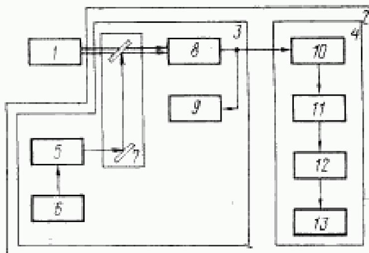
1—последующий лазер; 2—СИ; 3—оптическая часть СИ; 4—измерительно-индикационная часть СИ; 5—опорный лазер-тетеродия; 6—устройство управления частотой; 7—оптическая система; 8—измерительный преобразователь; 9—устройство контроля; 10—усилитель-ограничитель; 11—частотный детектор; 12—фильтр нижних частот; 13—регистрирующее устройство
