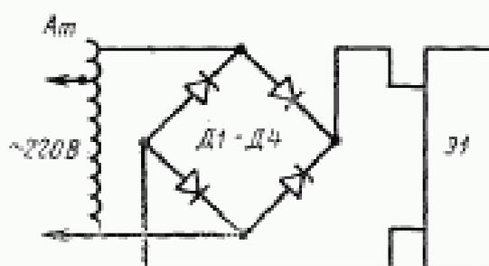
Д1—Д4—полупроводниковый диод КД202Р;
