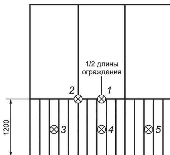
1 — середина длины ограждения; 2 — соединение «стойка опорная — перила ограждения»; 3, 4, 5 — центр экрана заполнения ограждения
