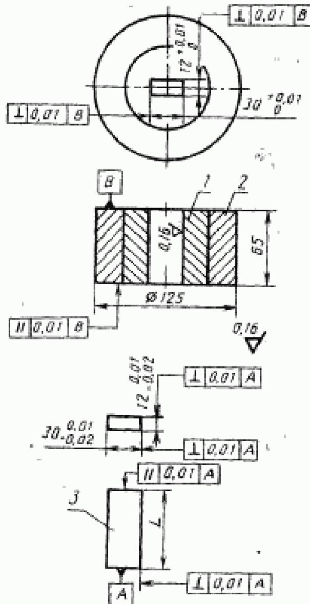
1 — стальной кольцо; 2 — металлокерамический твердый сплав; 3 — верхний пуансон и нижний
