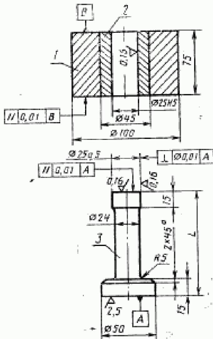
1 — стяжное кольцо, 2 — металловитерамический твердый сплав, Ж — верхний пуансон и нижний
