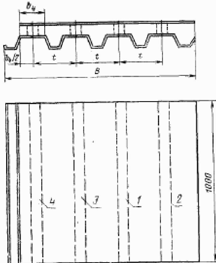
Места вырезки образцов для определения:
