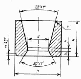
Примечание. По заказу потребителя допускается изготовление волокзаготовом с каналами радиального профиля, при этом размеры D, d, H берут по табл, 1, а остальные размеры устанавливаются по соглашению потребителя и изготовителя.
