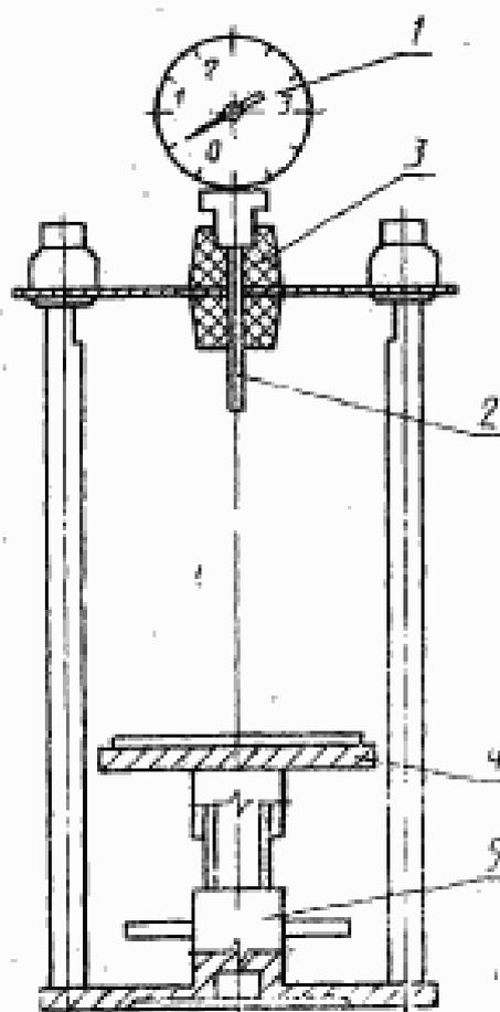
1 — манометр; 2 — игла; 3 — уплотнительная прокладка; 4 — площадка прессы; 5 — винт
