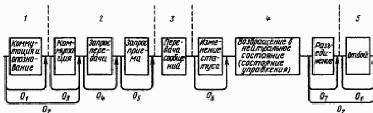
1 — фаза 1: установление соединения в коммутируемой сети; 2 — фаза 2: установление звена ПД; 3 — фаза 3: передача сообщений; 4 — фаза 4: завершение передачи; 5 — фаза 5: разъединение в коммутируемой сети
