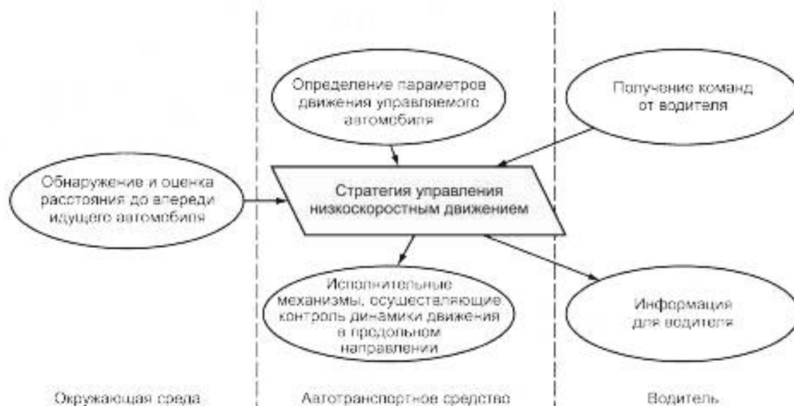
Рисунок 1 — Функциональные элементы системы LSF
