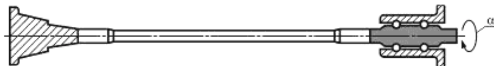
Рисунок 7 — Бурильная труба. Испытание по определению крутящего момента на колонне
