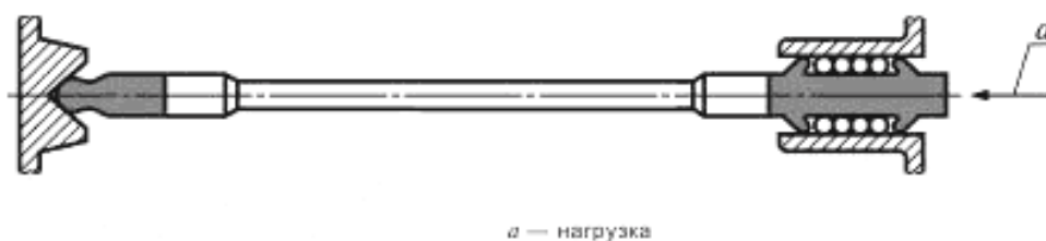
Рисунок 6 — Бурильная труба. Испытание по определению усилия на колонне
