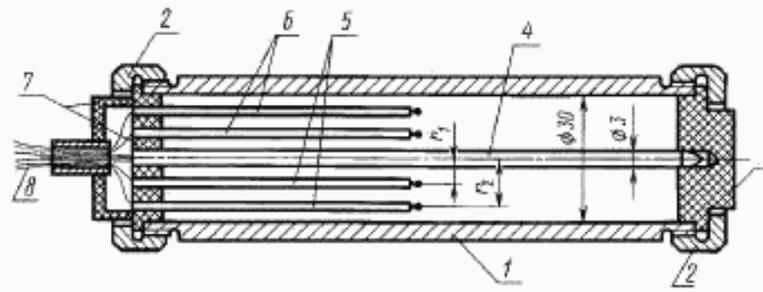
1 — корпус; 2 — накладная гайка; 3 — крышка; 4 — нагреватель; 5, 6 — термопары; 7 — крышка;
