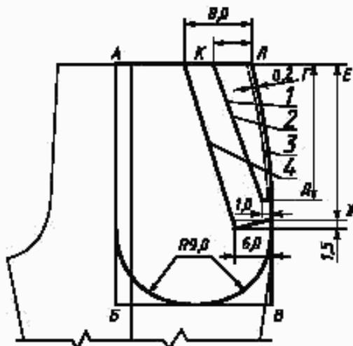
1 — край верхней части подкладки бокового кармана; 2 — линия перегиба бокового кармана и среза подкладки; 3 — подкладка и боковой карман; 4 — подзор бокового кармана
