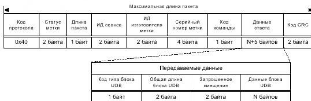
Рисунок 9 — Ответ радиочастотной метки на команду «Collection with UDB»
