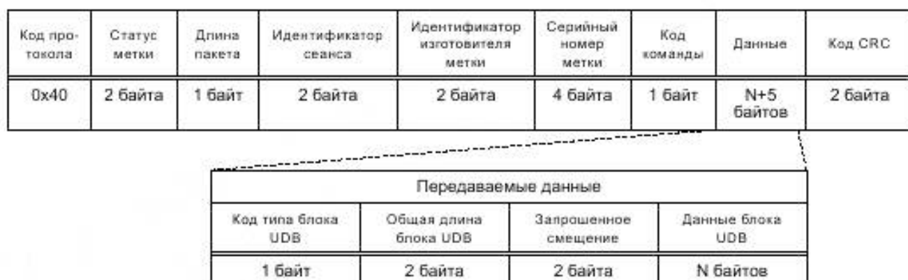
Рисунок 11 — Ответ радиочастотной метки на запрос дополнительной информации с помощью частной команды «Read UDB»
