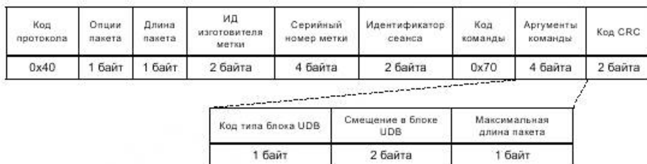
Рисунок 10 — Частная команда УСО конкретной радиочастотной метке для получения оставшейся части данных блока UDB
