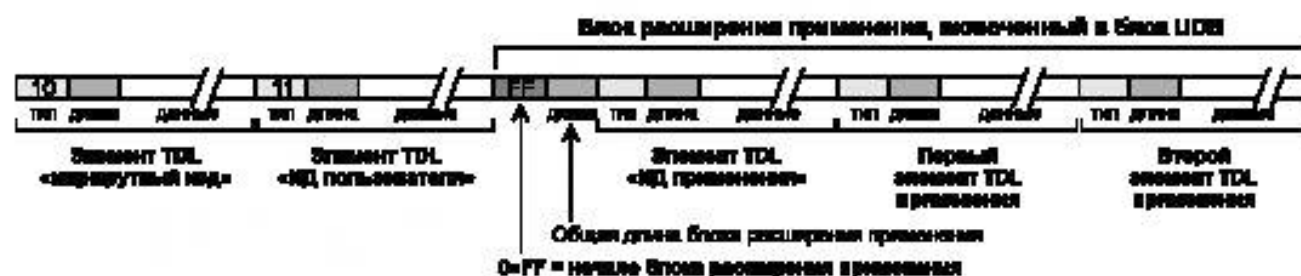
Рисунок 3 — Пример универсального блока данных (блока UDB) типа 0x00
