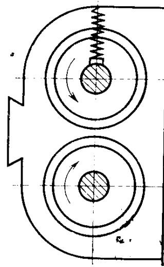
**Термин****Определение****Схема****6. Роторная дробилка**
