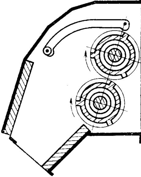
**Термин****Определение****Схема****10. Комбинированная дробилка**
