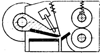
**11. Щековая дробилка с простым движением щеки**
