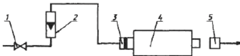
Рисунок 3 – Схема установки для определения наличия пыли регенеративного продукта
