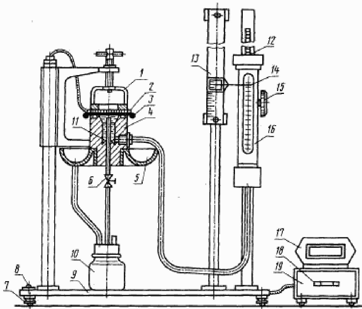
2.2. Прибор состоит из следующих основных частей: головки 4, напорного резервуара 16, измерительной линейки 13, сливного резервуара 10 и пульта управления 19.
