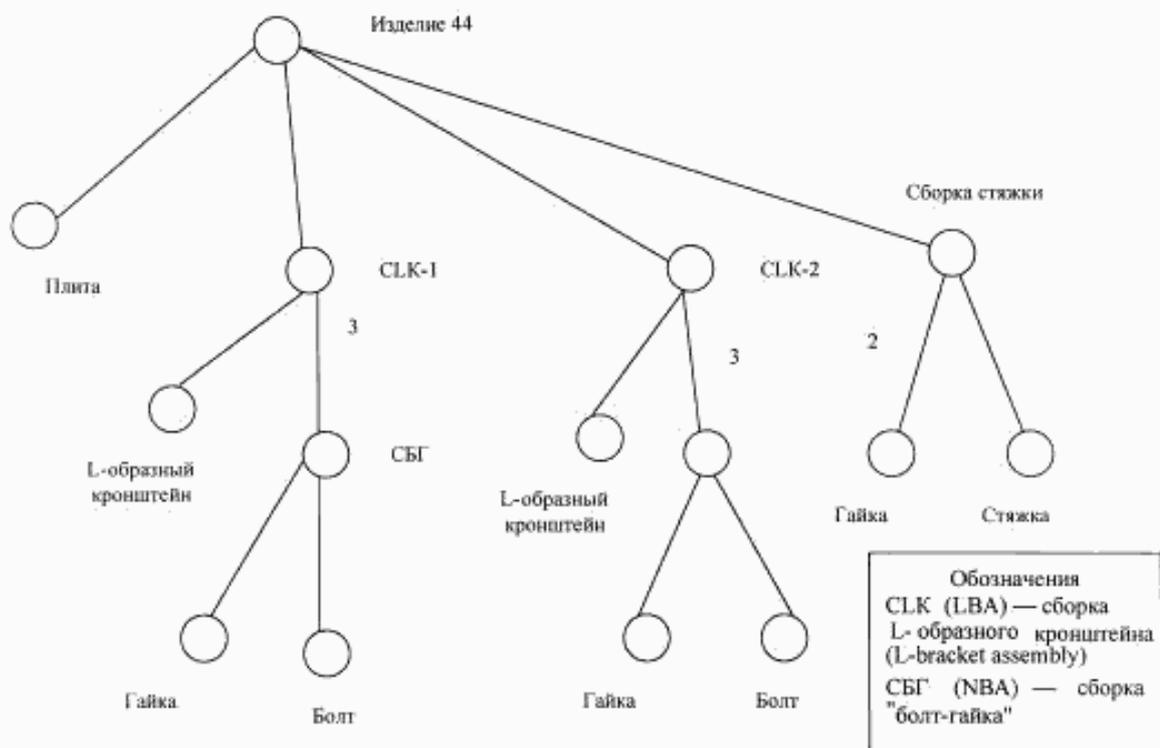
Рисунок E.2 — Схематическое представление структуры «изделия 44»
