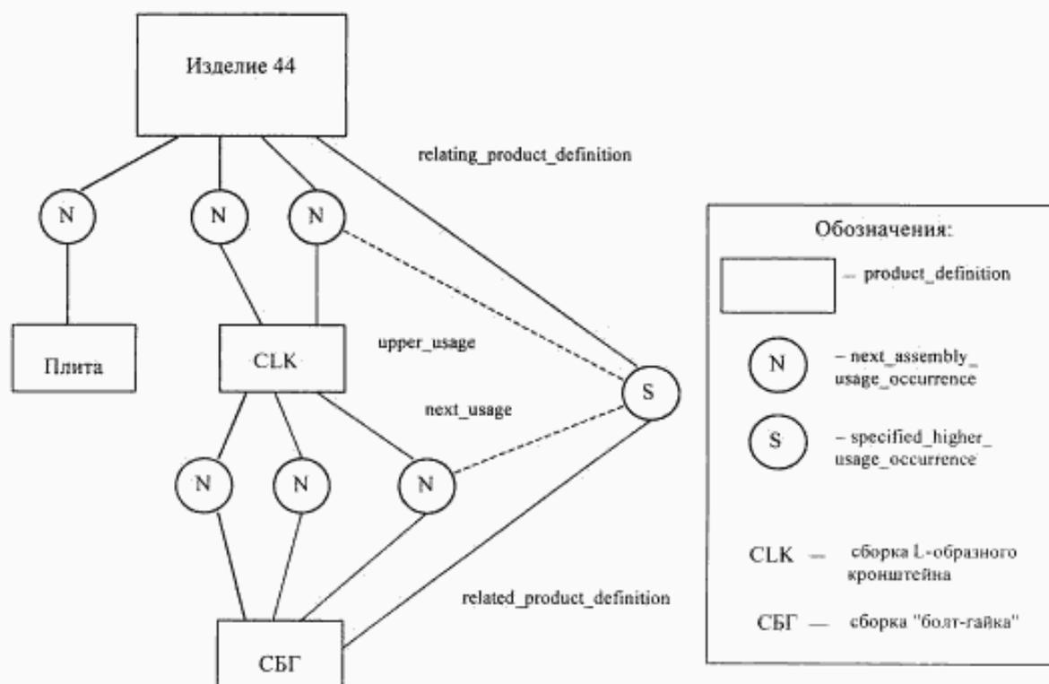
Рисунок E.7 — Пример структуры данных списка частей с использованием объектов настоящего стандарта
